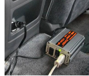
インバーター シガーソケットとの接続
