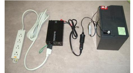
インバーター バッテリーとの接続
